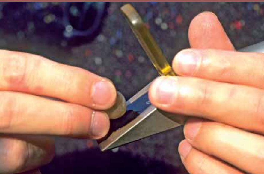
Die Qualitätskontrolle setzt schon im Weinberg ein: Messung des Mostgewichtes mit dem Refraktometer
